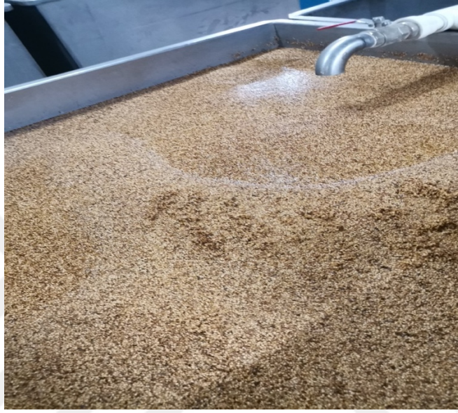
Şekil 2.8. Bozkır tahini üretiminde suda bekletme işlemi
