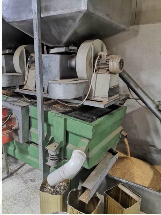
Şekil 2.11. Bozkır tahini üretiminde kullanılan titreşimli eleme sistemi
