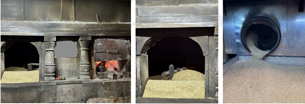
Şekil 2.10. Bozkır tahini üretiminde uygulanan kavurma işlemi
