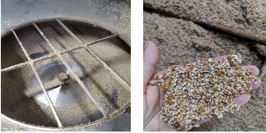
Şekil 2.9. Bozkır tahini üretiminde kabuk soyma işlemi
