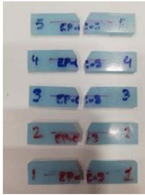
Şekil 4.5 Deney numunelerinin Mode-I kırılma tokluğu testi sonrası görüntüleri (EP-C-3)
