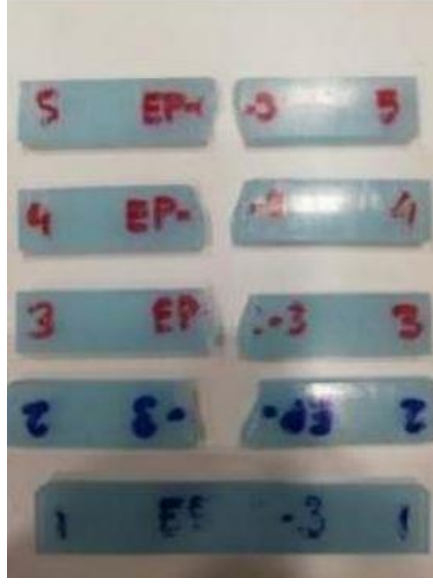
Şekil 4.9 Eğme yükü altında hasara uğramış deney numunelerinin görüntüleri
