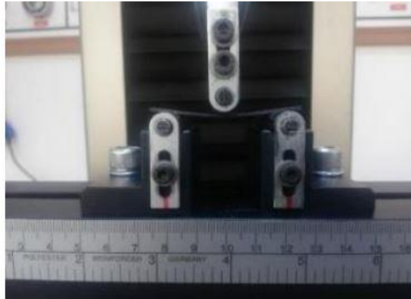
Şekil 3.28 3-nokta eğme aparatı ve eğme yükü altındaki kompozit numune
