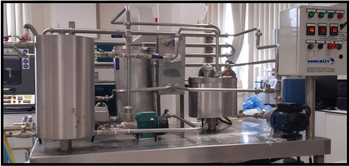
Şekil 3.2 Sütün pastörizasyonu için kullanılan ısıl işlem ünitesi
