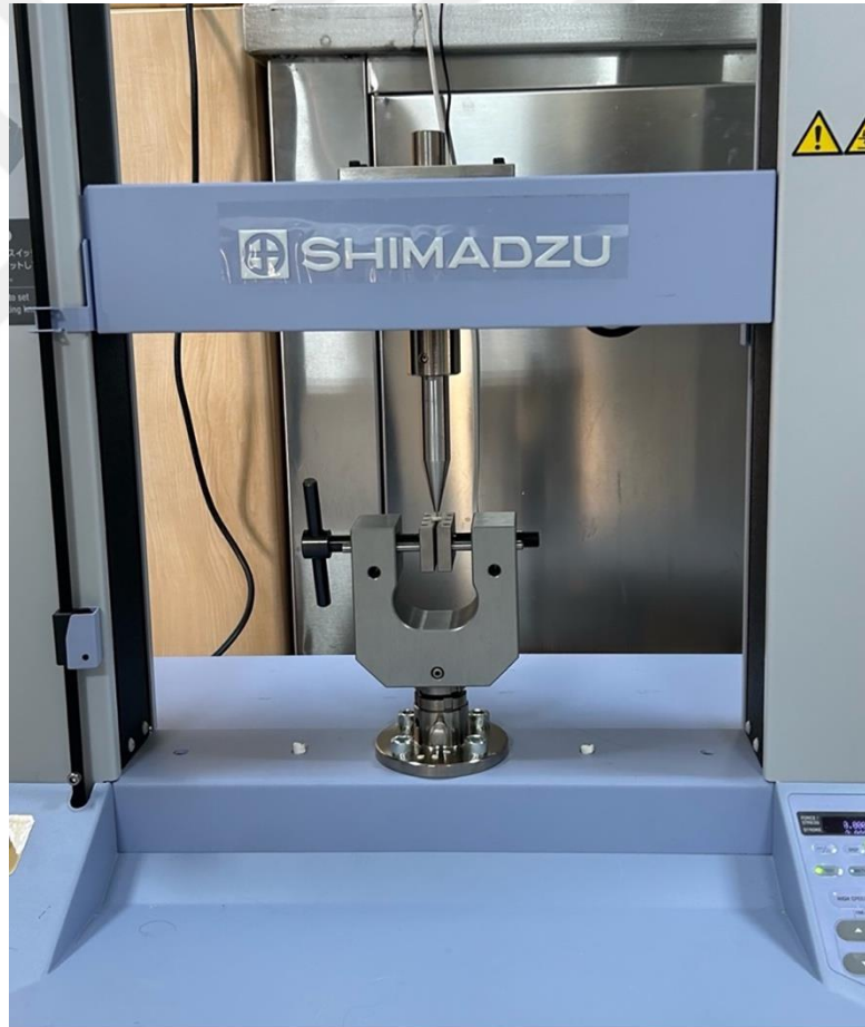
Şekil 3. 13. Bağlanma dayanımı testi için kullanılan evrensel test cihazı
