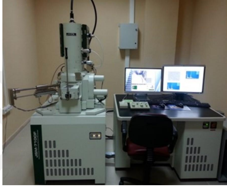
Şekil 3.6 Lif görüntülerinin alındığı SEM cihazı
