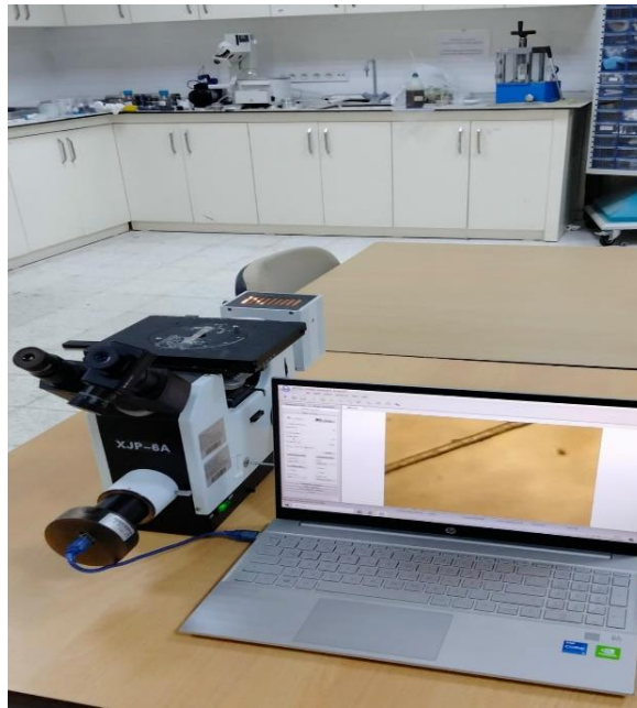
Şekil 3.5 Lif Görüntülerinin İncelendiği Optik Mikroskop Cihazı
