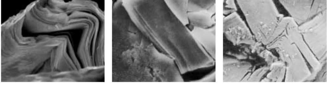
Şekil 2.9 a) Bir kuvvetin Ti_3SiC_2 örneğinin yüzeyinden geçtiğinde ortaya çıkan katmanlar b) Mekanik bir girinti ile kasıtlı olarak ortaya çıkan hasar c) Meydana gelen burkulmalar [1]
