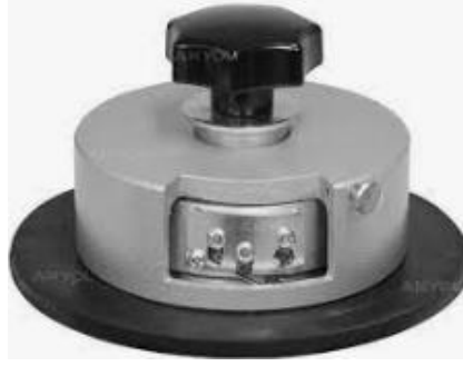
Şekil 4.22 Kumaş gramaj ölçümü için numune alma aparatı
