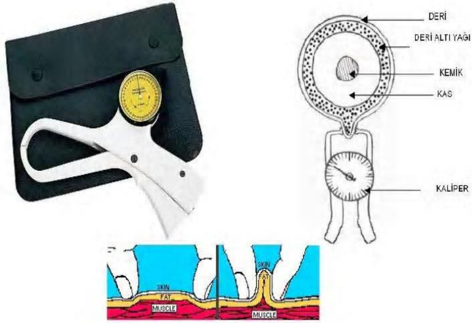
Resim: 3.1 Holtain kaliper ve deri kıvrım kalınlığı ölçüm yöntemi (Özkaya, 2010).
