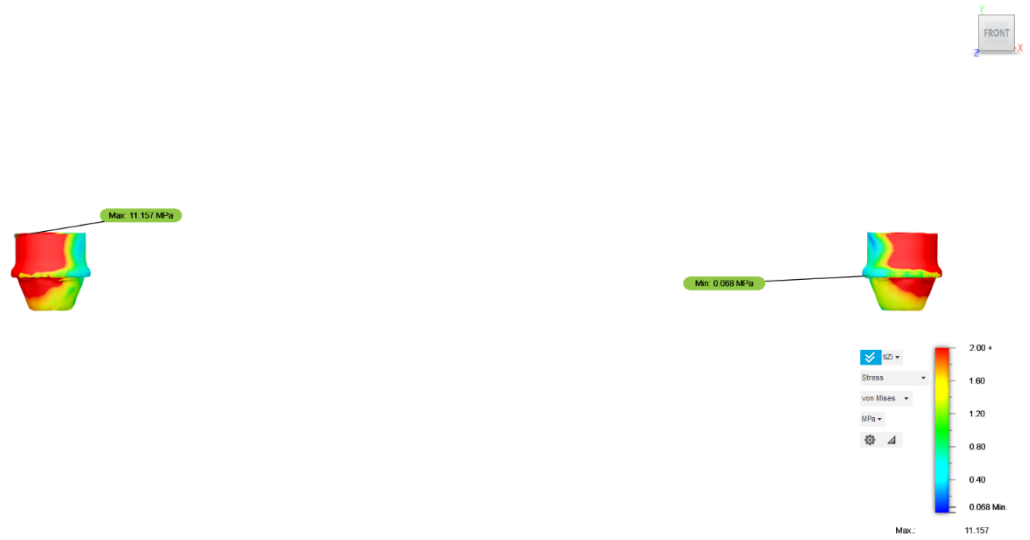
Şekil 4.69. Model 6'da dikey yükleme sonrası dayanak bileşenlerinde oluşan von Mises gerilme dağılımı
