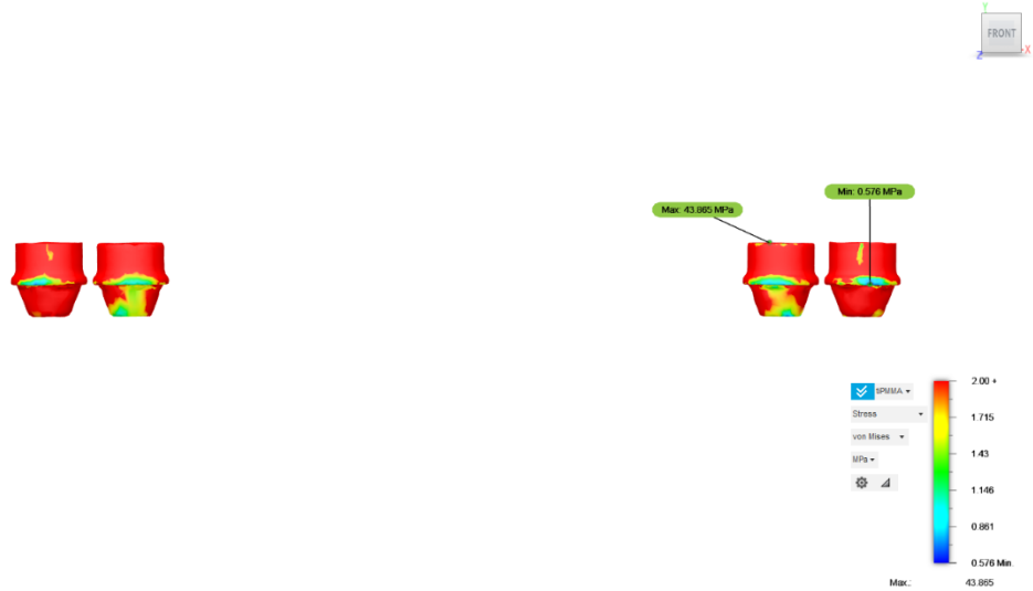
Şekil 4.80. Model 7’de oblik yük altında anterior zigomatik implantlarda von Mises gerilme dağılımı
