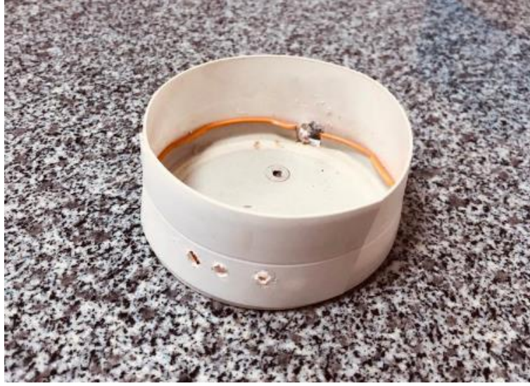
Şekil 3.26 Su sızdırmaz bant ile oluşturulan hazne
