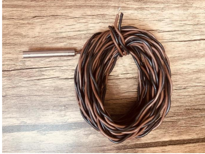
Şekil 3.12 Deneyde kullandığımız sıcaklık sensörleri
