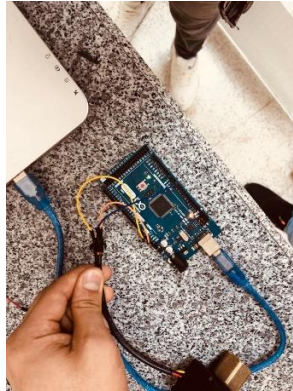
Şekil.3.10 Debimetrenin Ardino’ya Bağlanması
