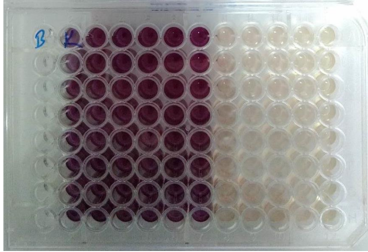
Şekil 8. Atropinin etkisini saptamak amacıyla yapılan MTT analizinde kullanılan 96 kuyulu plakta tüm gruplara ait kuyucuklarda çözünmüş formazan kristalleri. Plakta 2,5 \times 10^{-3} M konsantrasyon grubunun bulunduğu 8. sıradan (dikey soldan) itibaren proliferasyonun aniden kesildiği sitotoksik etkinin olduğu görülmektedir.
