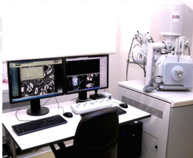
Şekil 3.8 FEI marka Quanta 650 Field Emission SEM model taramalı elektron mikroskobu (Url-2).
