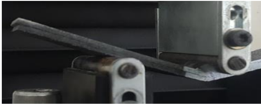
Şekil 4.2 ENF numunesinin P_{max}-\delta_{max} noktasındaki durumu.
