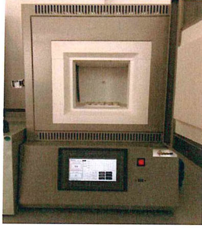
Şekil 3. 9 Sinterleme aşamasında kullanılan fırına numunenin yerleştirilmesi ve sinterleme sonrası numuneler
