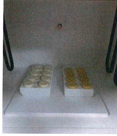
Şekil 3. 9 Sinterleme aşamasında kullanılan fırına numunenin yerleştirilmesi ve sinterleme sonrası numuneler
