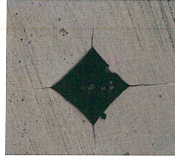
Şekil 3. 12 Elmas piramit ucun bıraktığı iz ve izin köşegenleri
