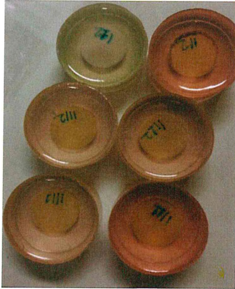
Şekil 3. 10 Soğuk kalıplanan numuneler ve kullanılan parlatma cihazı
