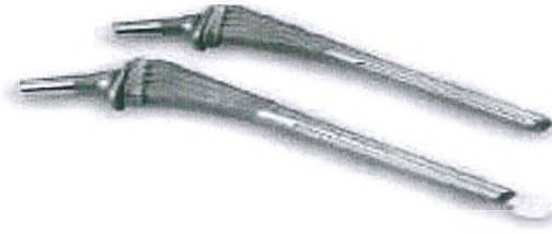
Şekil 2. 5 Kobalt-krom alaşımından yapılmış bir kalça protezi (Özkan vd. 2016)
