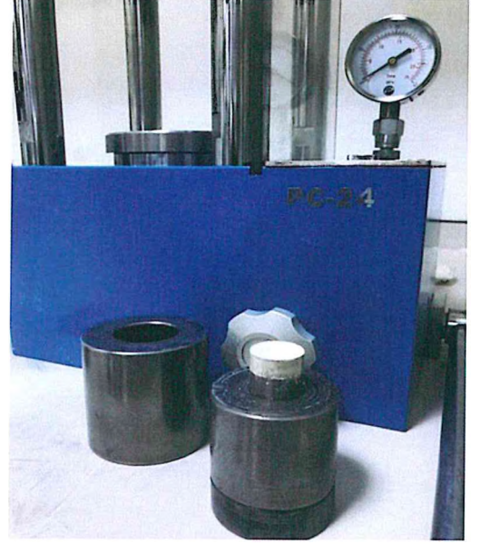
Şekil 3. 4 Kuru presleme yönteminde kullanılan pres ve elde edilen numune
