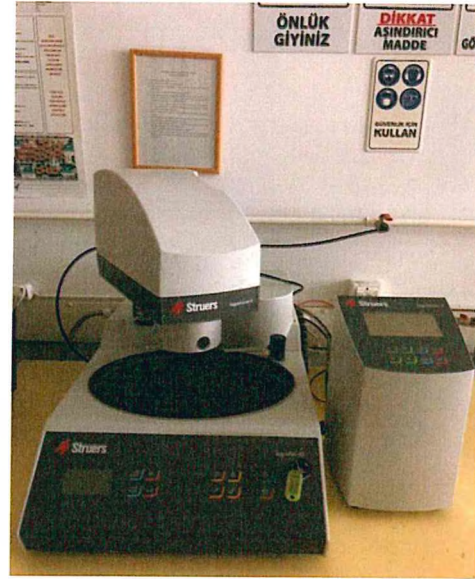
Şekil 3. 10 Soğuk kalıplanan numuneler ve kullanılan parlatma cihazı
