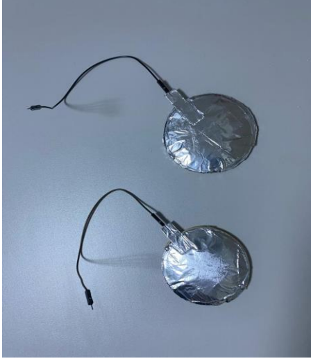
Şekil 3.5 Triboelektrik özellikleri incelenen film yapının test aşaması.
