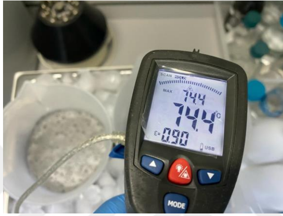
Şekil 3.1 MAX fazı tozlarının HF asit içerisinde MXene faza geçişi.
