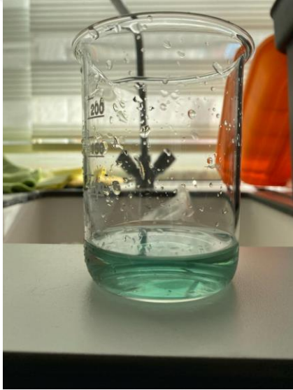
Şekil 3.3 Santrifüj işlemi ve yapının MXene faza dönüşmesinin ilk muayenesi.
