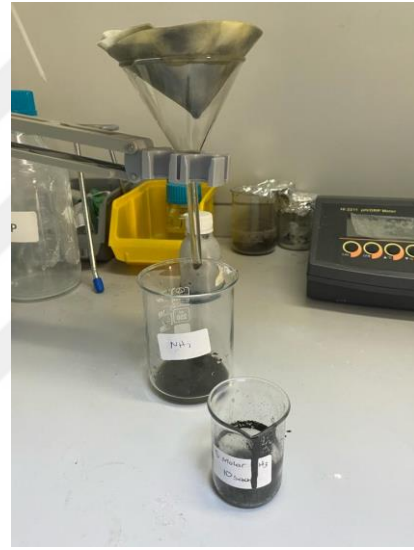
Şekil 3.2 Asidik aşındırma işlemi sonrasında yapıdaki asidin uzaklaştırılması.
